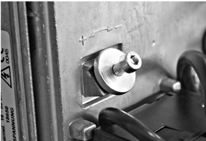
Abb. 11: Verstellerschraube der Luftklappe
