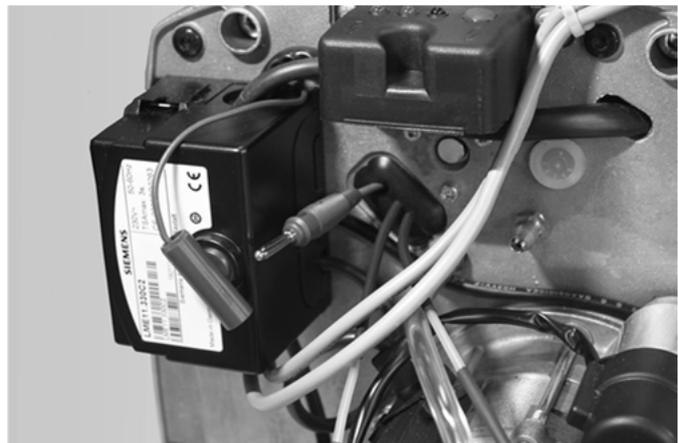
Abb. 20: Getrennte Steckverbindung der Ionisationselektrode
