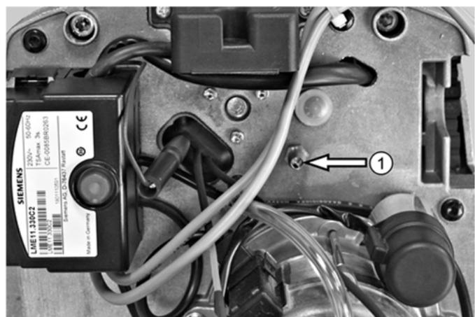
Abb. 8: Messnippel (Messing) zur Bestimmung der Gebläsepression
