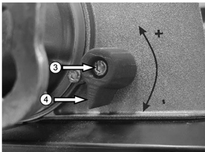
Abb. 10: Verstellung der Luftklappe
