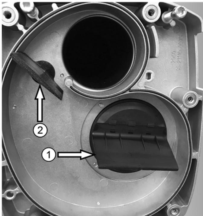
Abb. 9: Lufteinlaufdüse ① mit Winkel und Luftklappe ②
