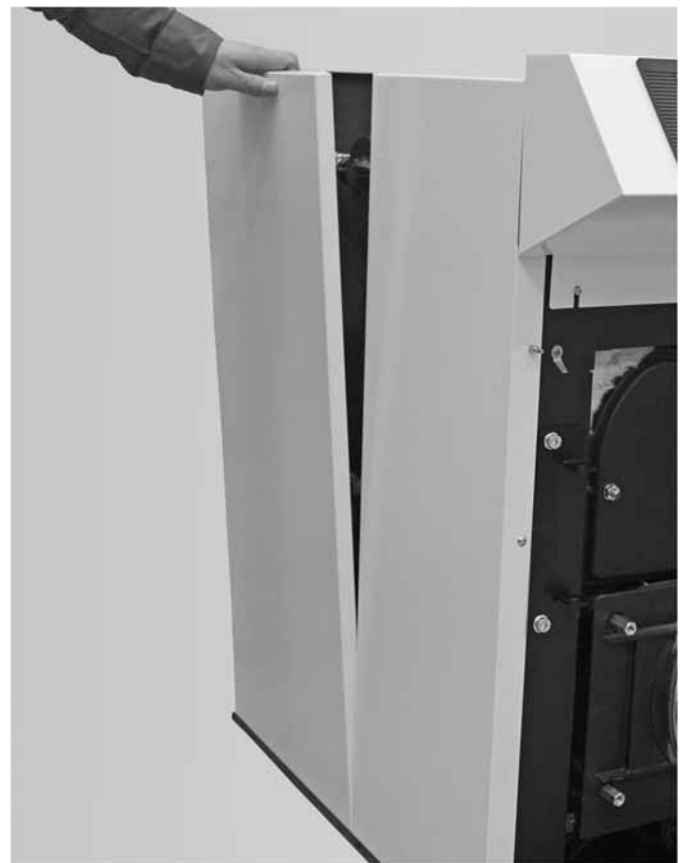
Abb. 5: Demontage der seitlichen Verkleidung
