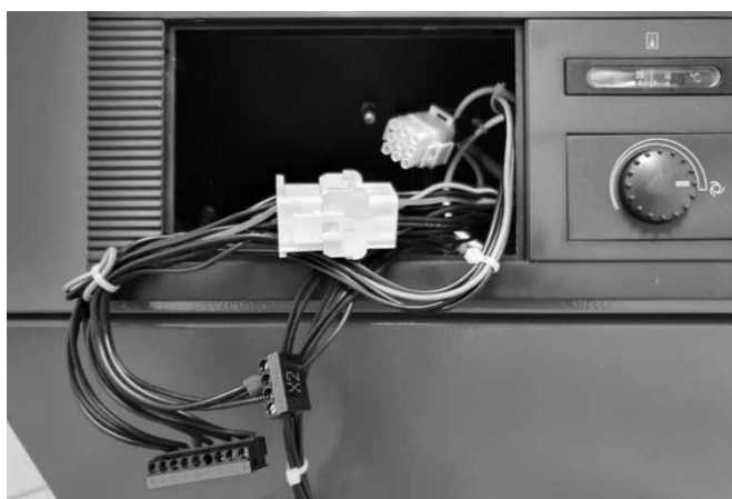
Abb. 105: Getrennte Anschlussstecker für den Regler.
