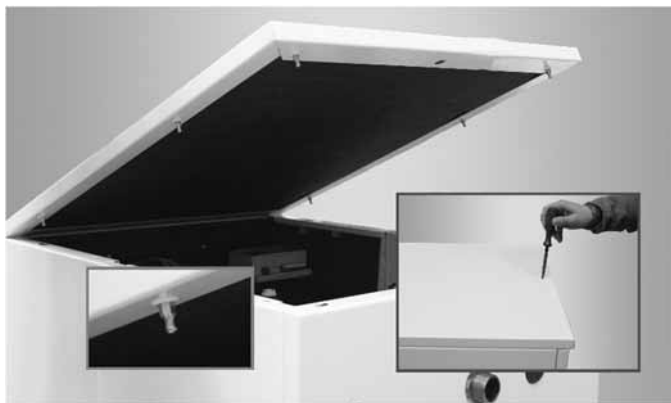
Abb. 80: Demontage der oberen Verkleidung
