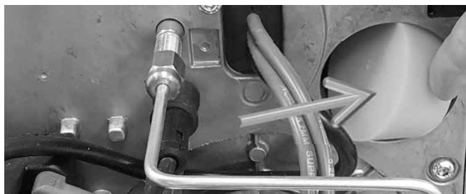
Abb. 10: Einsetzen des Silikon-Stopfens
