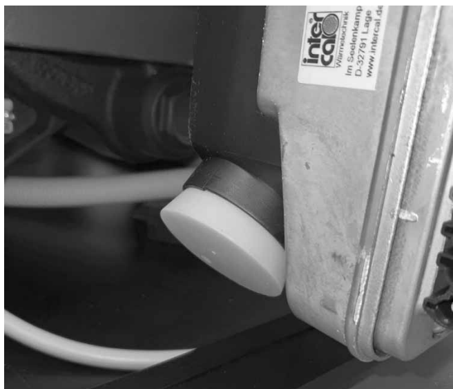
Abb. 8: Zuluftstopfen im Ansaugschalldämpfer
