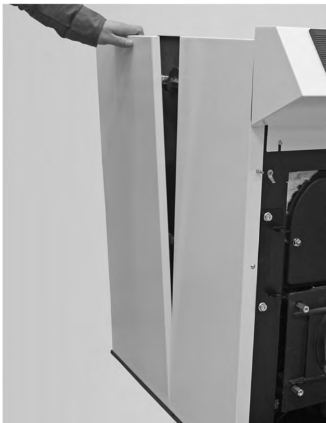
Abb. 83: Demontage der seitlichen Verkleidung
