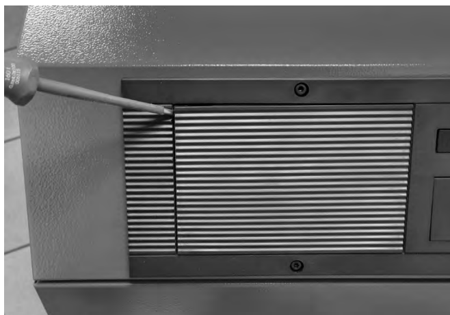
Abb. 29: Demontage der Blindabdeckung
