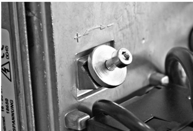
Abb. 11: Verstellechraube der Luftklappe
