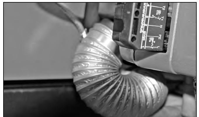
Abb. 21: Montage des RLU-Zuluftschlauchs
