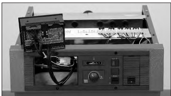
Abb. 31: Reglerkabelsatz in den Steckverbinder stecken, Anschlussklemmen am Regler aufstecken und Anschlussklemmenwinkel auf der Traverse einclippen. Kesselfühler parallel zu den Kapillarrohrfühlern verlegen und auch tief in die Tauchhülse einführen.
