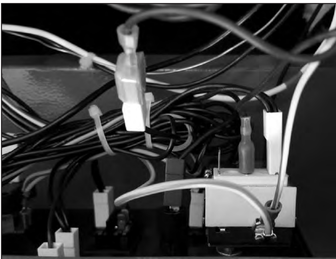
Abb. 38: Reihenschaltung der Sicherheitsthermostaten und Kombination der Schutzleiteranschlusstecker.
