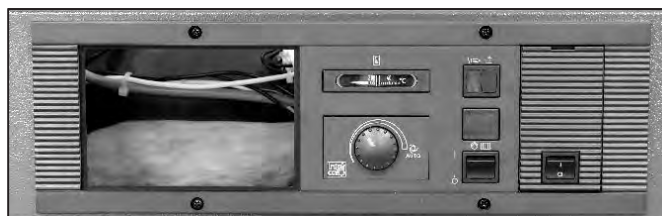
Abb. 28: Reglerschachtabdeckung von hinten herausdrücken.
