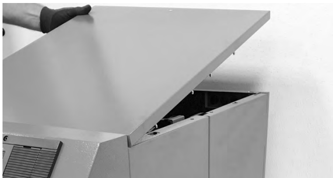
Abb. 79: Demontage der oberen Verkleidung
