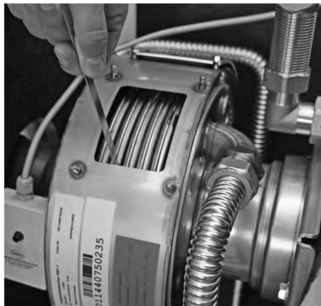
Abb. 90: Anwendung der Reinigungsklinge
