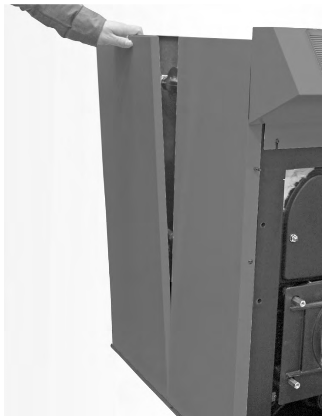
Abb. 82: Demontage der seitlichen Verkleidung
