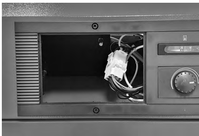
Abb. 29: Offener Reglerschacht mit Steckverbindung für den Regler-Kabelbaum.
