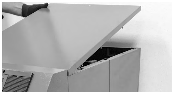
Abb. 4: Demontage der oberen Verkleidung
