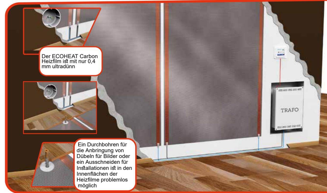
Die ECOHEAT Carbon-Flächenheizung arbeitet völlig unsichtbar „im Untergrund“ ohne sichtbare und platzraubende Heizkörper. Der dünne Heizfilm aus feinen Carbon-Fasern lässt sich ideal an Wänden, Decken oder auf dem Fußboden verlegen. Für den Betrieb ist dann nur eine niedrige Schutzspannung über einen Trafo notwendig, der platzsparend zentral installiert werden kann.
