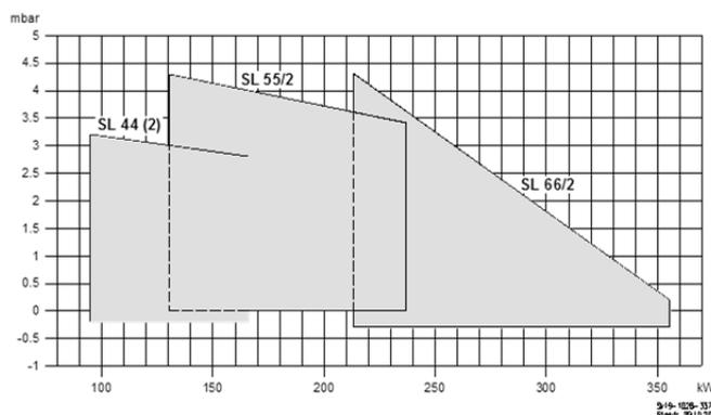
Abb. 27: Leistungsdiagramm SL 44 – SL 66/2
