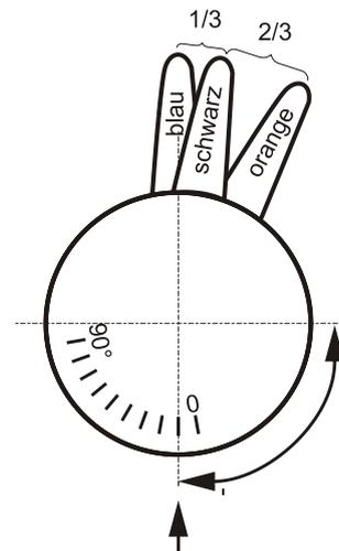
Abb. 12: Schaltpunkt Magnetventil
