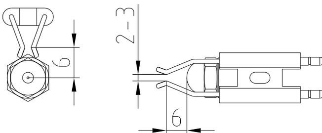
Abb. 20: Zündelektrodeneinstellung SL 44 – SL 66/2
