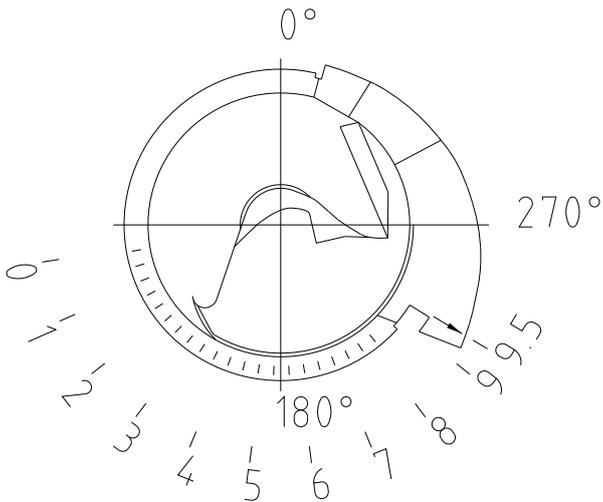
Abb. 15: Verstellen der Lufterlaufdüse beim SL 44 – SL 420/2
