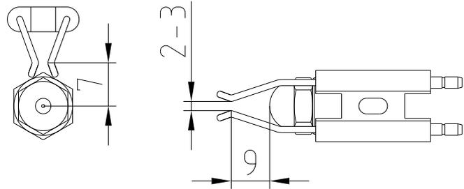
Abb. 21: Zündelektrodeneinstellung SL 400/2 – SL 420/2
