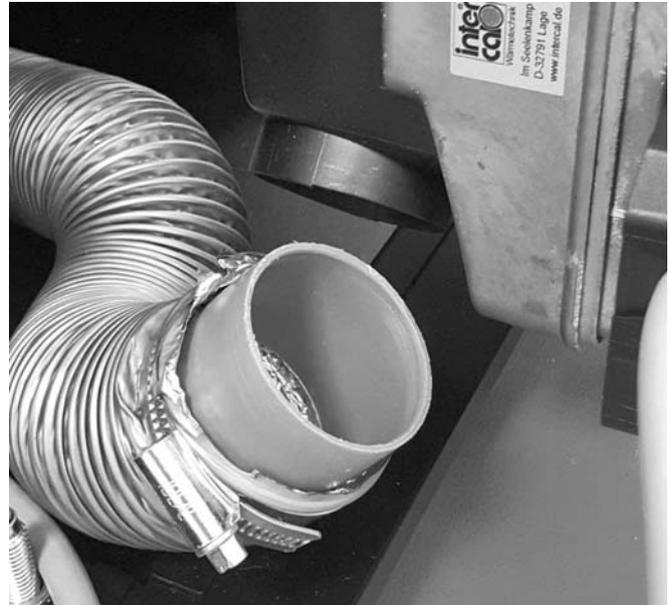
Abb. 13: Zuluftschlauch mit 50 mm Anschluss-Stück
