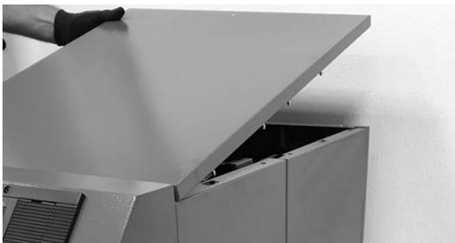
Abb. 26: Demontage des Verkleidungsdeckels
