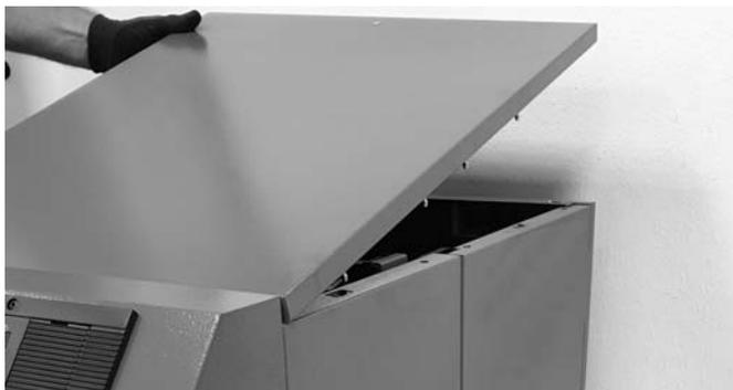
Abb. 79: Demontage der oberen Verkleidung
