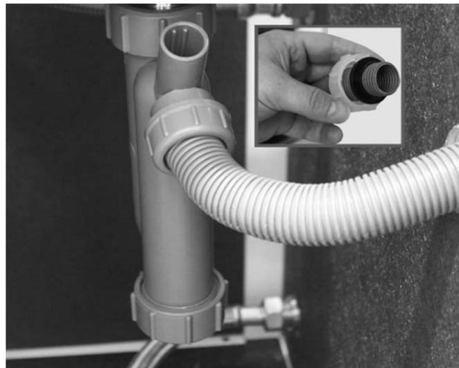
Abb. 16: Montage des Kondensatschlauchs
