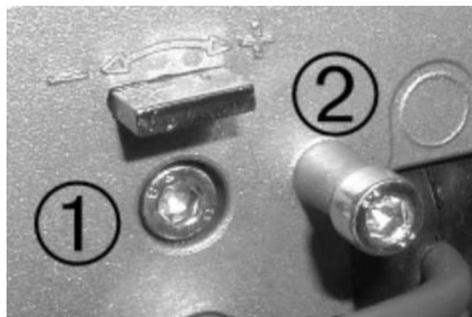
Abb. 75: Druckmessnippel (2)
