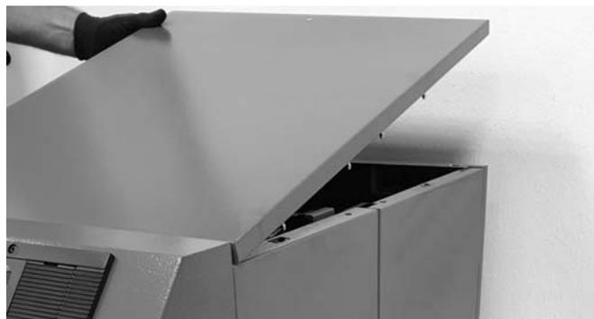
Abb. 4: Demontage der oberen Verkleidung
