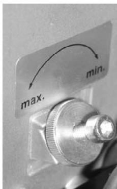
Durch die Verstellung der Luftklappe wird die Verbrennungsluft an die Ölmenge (Leistung) angepasst. Der Luftüberschuss - gemessen als CO<sub>2</sub>- oder O<sub>2</sub>-Anteil in den Verbrennungsabgasen - wird über die Luftklappe mit einem geeigneten Emissionsmessgerät an die Vorgaben in der Grundeinstellwerte angepasst.
