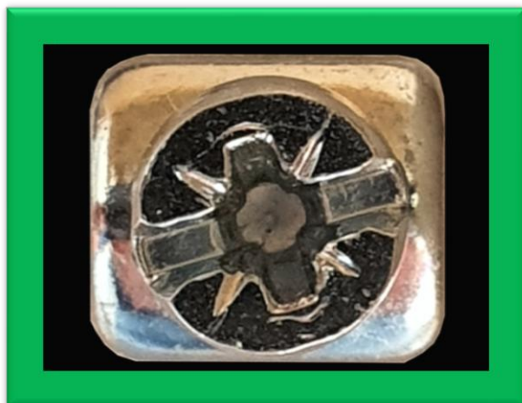
Klemmschraube mit glattrandiger Klemmplatte. Diese Schraube ist nicht potenziell schadhafte!
