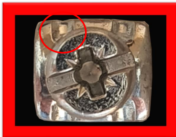
Klemmschraube mit 4-fach gekerbter Klemmplatte. Diese Schraube ist potenziell schadhafte!
