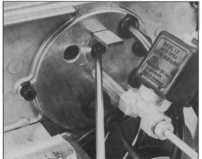
Bild 5: Sekundärlufteinstellung (Düsenstockverstellung)
