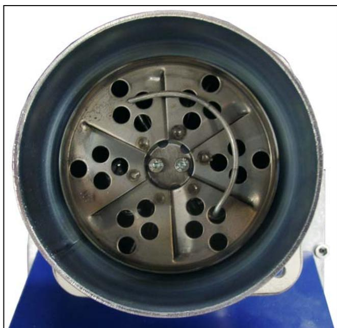
Abb. 14: Position Ionisationselektrode
