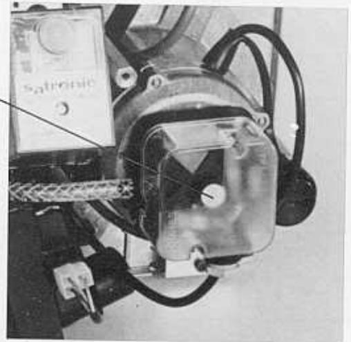
Der Gasdruckwächter soll sicherstellen, daß der Gasbrenner nur dann läuft, wenn ein ausreichender Gasdruck vorhanden ist.
