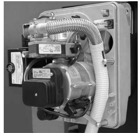
Abb. 9: Gasschlauch hinter den Schlauchhaltern verlegen und mit Schlauchschelle sichern.
