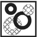
Grundsätzlich nach Teileausbau/-umbau neue Dichtungen verwenden.
