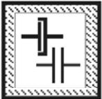
Flanschflächen schützen. Schrauben kreuzweise anziehen. Auf spannungsfreien Einbau achten!
