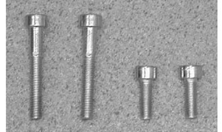
Abb. 6: Befestigungsschrauben für den Gasschlauchflansch.
