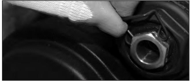
Abb. 72: Sicherungsfeder an der Fühlertauchhülse am Kesselblock abnehmen.
