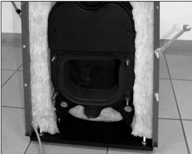
Abb. 69: Tür-Haltebolzen auf der rechten oder linken Seite oben und unten einschrauben.
