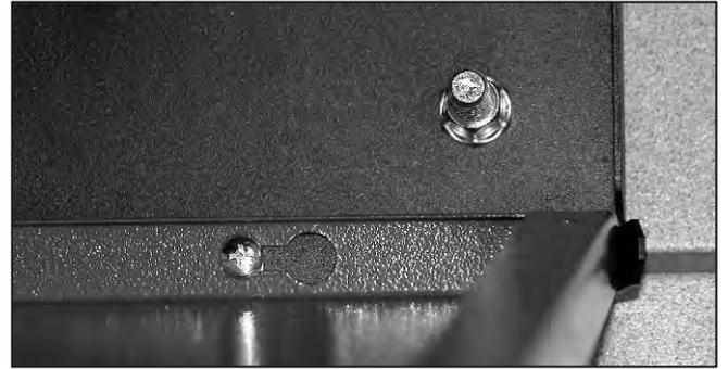
Abb. 53: Seitenverkleidungen auf die Schrauben stecken und bis zum Anschlag der Blechungen nach vorne schieben. Unter Druck nach außen die Schrauben fest anziehen.
