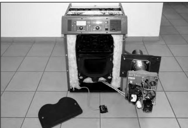
Abb. 133: Bei demontiertem Abgaswärmetauscher die Vorderseite des Kessels öffnen und die Brennertür in die Wartungsposition bringen. Jetzt kann der Kessel mit einer Bürste gereinigt und ausgesaugt werden.
