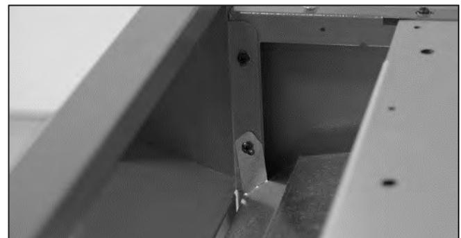
Abb. 67: das Schutzblech zusammen mit den unteren Schaltfeldträgerschrauben rechts und links befestigen. Für die oberen Schrauben Zahnscheiben verwenden.
