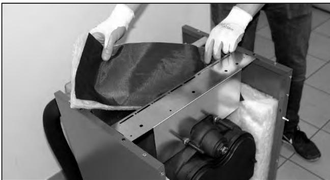
Abb. 57: Obere, breite Isolierung in der Mitte einlegen.
