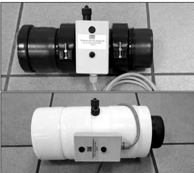
Abb. 129: Abgasanschlüssen an den Flanschverbindungen trennen.
