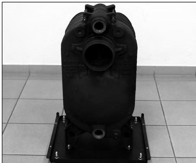
Abb. 23: Kunststoffstopfen vom Vor- und Rücklaufanschluss entfernen.
