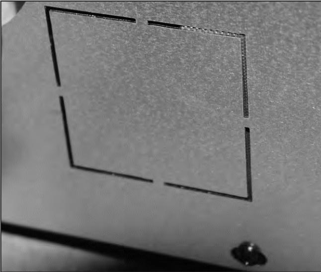
Abb. 101: vorgestanzten Ausschnitt in der Kesselrückwand öffnen und die Glaswolle mit einem Cutter-Messer ausschneiden.
