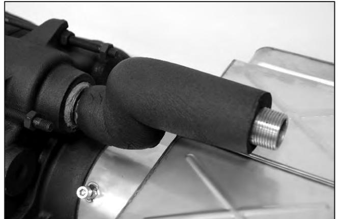
Abb. 42: Mit einem kurzen Stück Isolierschlauch das Vorlaufrohr isolieren.
