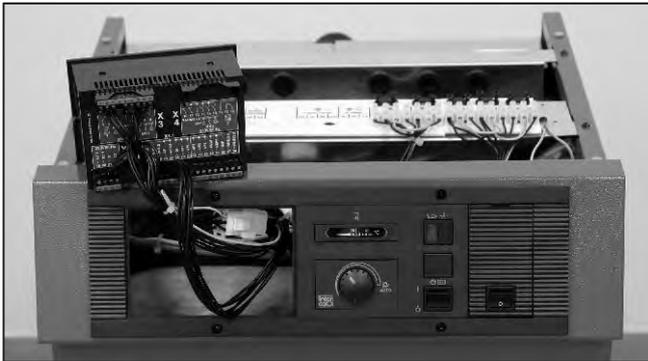
Abb. 124: Reglerkabelsatz in den Steckverbinder stecken, Anschlussklemmen am Regler aufstecken und Anschlussklemmenwinkel auf der Traverse einclippen. Kesselfühler parallel zu den Kapillarrohrfühlern verlegen und auch tief in die Tauchhülse einführen.
