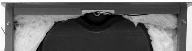
Abb. 75: Kapillarrohre verlegen und Sicherungsfeder wieder einsetzen.
