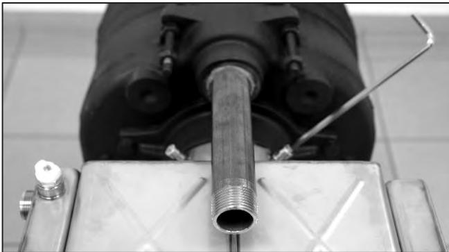
Abb. 34: Klemmschrauben anziehen, dass ein fester Halt gewährleistet ist.
