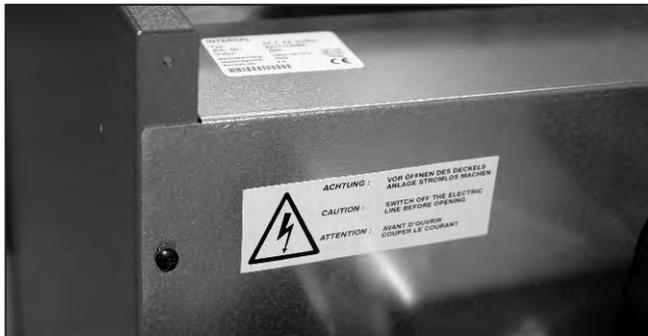
Abb. 96: Aufkleber "Stromlos machen" und Kesselschaltfeld Typenschild auf Rückwand aufkleben.
