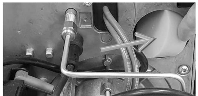
Abb. 10: Einsetzen des Silikon-Stopfens
