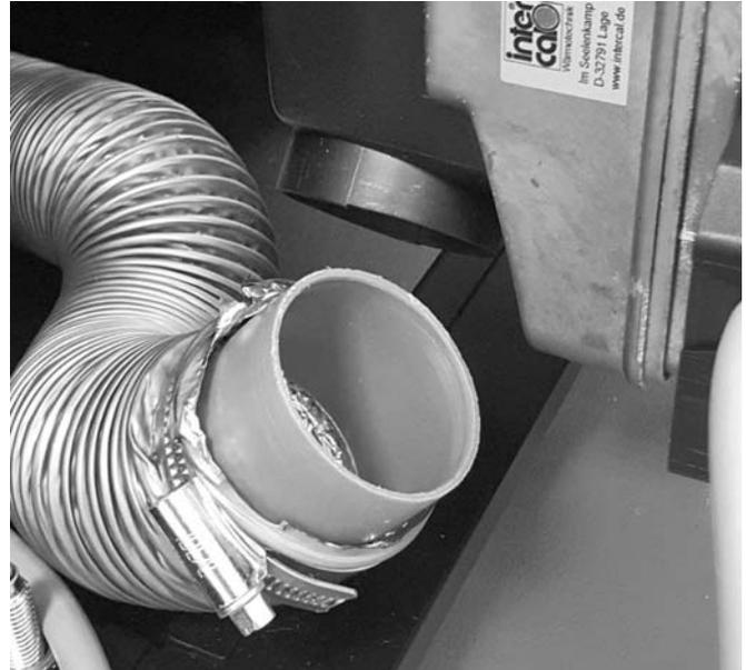
Abb. 13: Zuluftschauch mit 50 mm Anschluss-Stück
