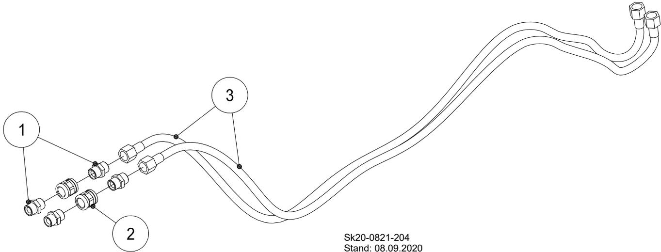
Abb. 101: Öl- bzw. Gasversorgung ECOHEAT Plus...
