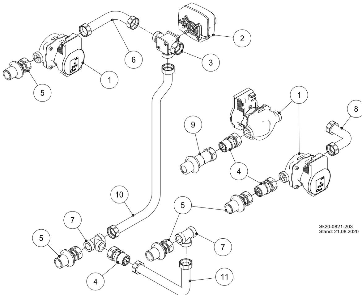
Abb. 100: Maximale Hydraulikausrüstung mit Mischerkreis, Direktkreis und Speicherladekreis ECOHEAT Plus...
