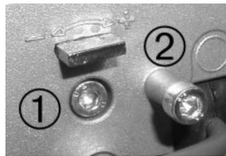
Am Druckmessnippel (2) kann der Mischdruck abgenommen werden.
