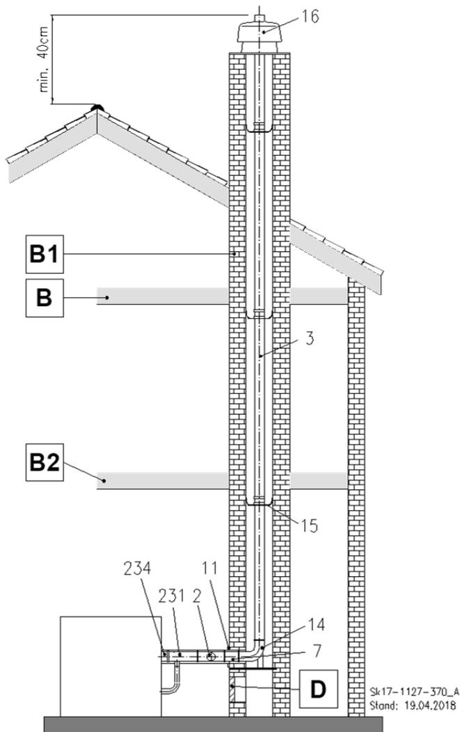
Abb. 53: C<sub>93x</sub> Abgasrohr im Schacht
