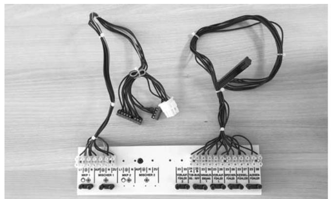
Abb. 32: Regler-Kabelbaum mit Klemmen und Steckverbinder zum Kesselschaltfeld.
