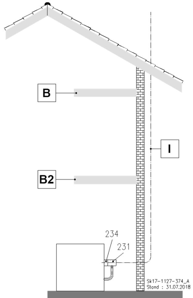
Abb. 50: C<sub>63x</sub> Für Anschluss an eine nicht mit der Gasfeuerstätte geprüfte Verbrennungsluftzuführung und Abgasabführung
