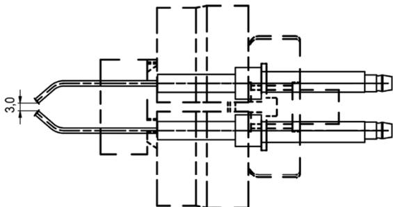
Abb. 97: Der Elektrodenabstand ist 3,0 mm
