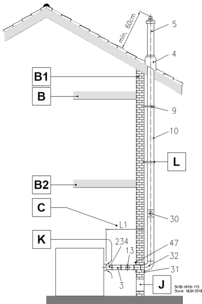
Abb. 43: B<sub>23</sub> Abgasrohr an der Außenwand
