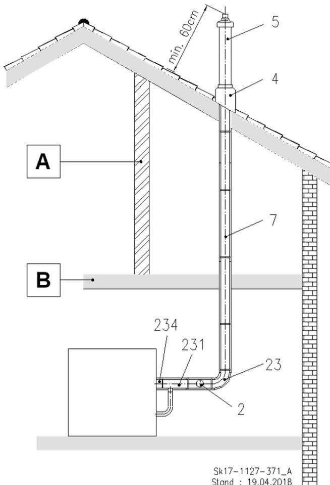
Abb. 47: C<sub>33x</sub> Luft-Abgas-Rohrsystem senkrecht durch eine Decke und eine Dachhaut
