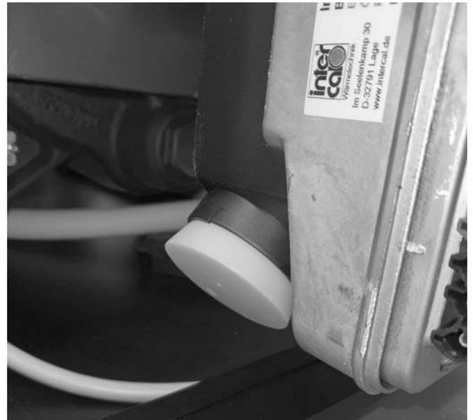
Abb. 8: Zuluftstopfen im Ansaugschalldämpfer
