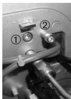
Rechtsdrehen der Stellschraube (1) öffnet, linksdrehen schließt den Rezirkulationsspalt. Ein Anhaltswert kann an der Skala abgelesen werden. Das Luftverhältnis wird dabei nicht verändert.
