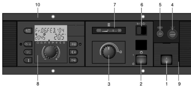
Abb. 70: Kessel-Grundschaltfeld (mit THETA+ Regelung - Ausführung Medium oder Premium oder Zubehör)
