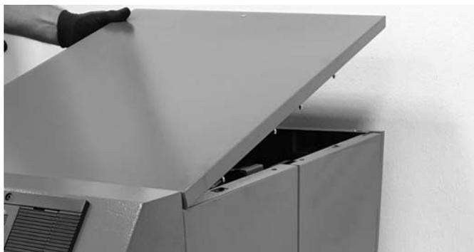
Abb. 4: Demontage des Verkleidungsdeckels
