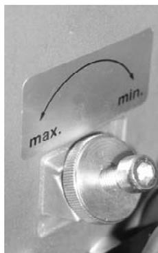
Durch die Verstellung der Luftklappe wird die Verbrennungsluft an die Ölmenge (Leistung) angepasst. Der Luftüberschuss - gemessen als CO<sub>2</sub>- oder O<sub>2</sub>-Anteil in den Verbrennungsabgasen - wird über die Luftklappe mit einem geeigneten Emissionsmessgerät an die Vorgaben in der Grundeinstellwerte aus Absatz 0 angepasst.
