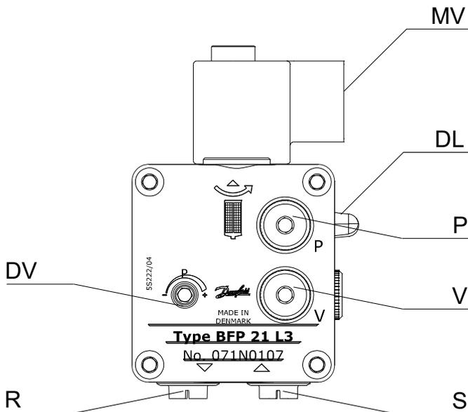
Abb. 77: Danfoss Ölpumpe BFP 21 L3 (Druckbereich 7-15 bar)
