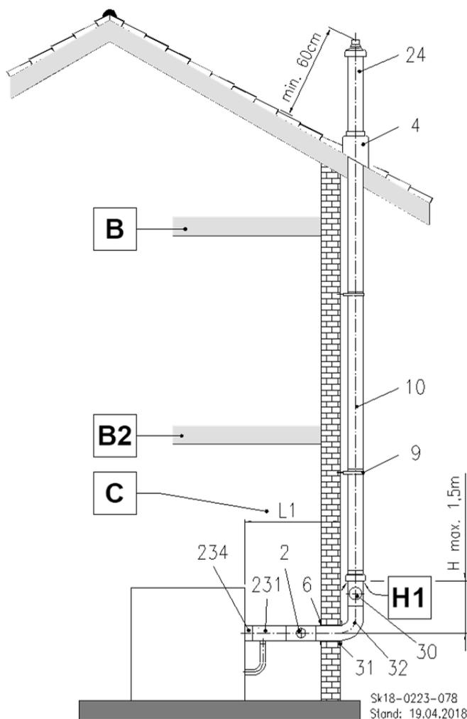
Abb. 49: C<sub>53x</sub> Außenwandführung LAS
