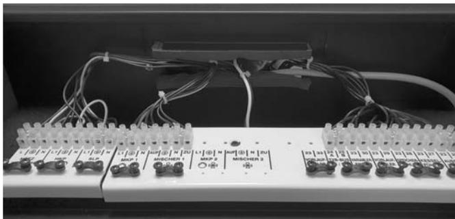
Abb. 33: Klemmenbrett in Montageposition mit eingeführten Kabeln im noch geöffneten Kabelschlitz.
