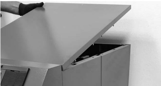
Abb. 28: Demontage des Verkleidungsdeckels
