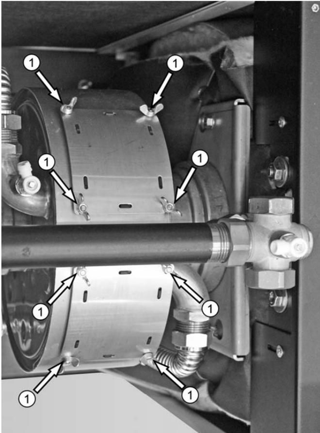
Abb. 89: Muttern ① der Reinigungsabdeckungen vom RWT
