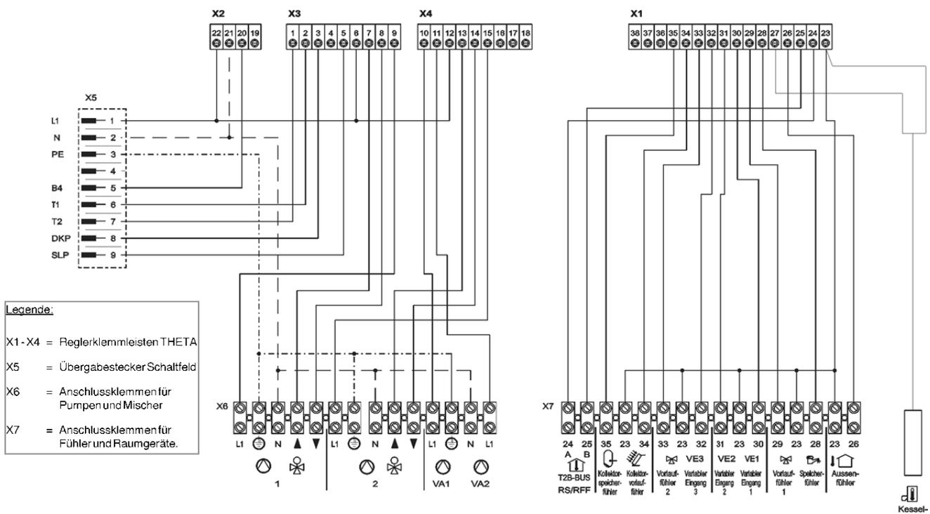
Abb. 40: Schaltplan Anschlusskabelbaum für THETA+ 233B und THETA+ 2233 BVV (Zubehör für Ausführung "Basis") bei Verwendung der Regelungen THETA+ 233B oder THETA+ 2233BVV
