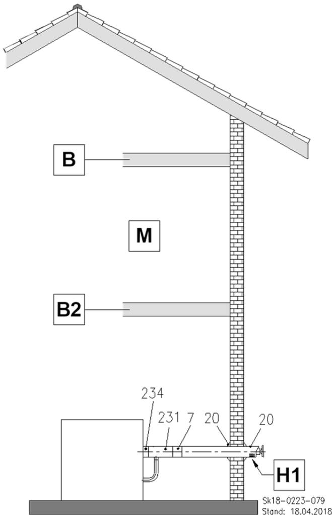
Abb. 46: C<sub>13x</sub> Luft-Abgas-Rohrsystem horizontal durch die Außenwand
