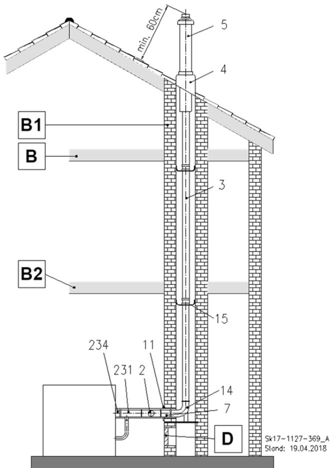
Abb. 52: C<sub>93x</sub> Luft-Abgas-System im Schacht und Luft-Abgas-Rohrsystem mit Dachdurchführung
