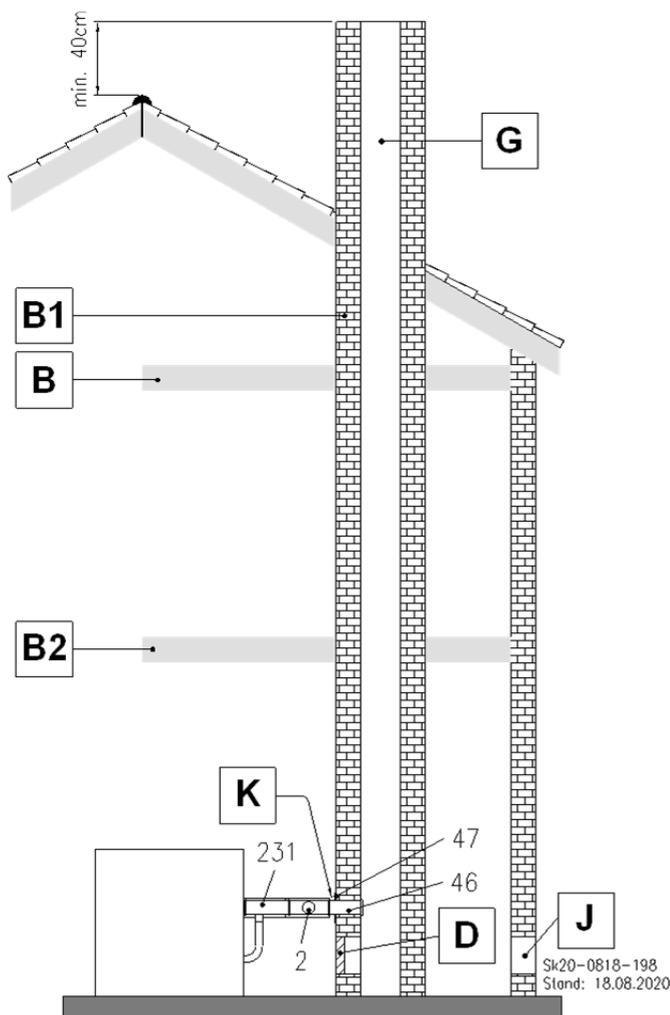
Abb. 45: B<sub>33</sub> Abgasrohr endet im feuchteunempfindlichen Schornstein
