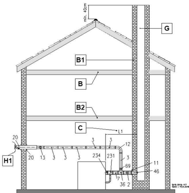
Abb. 51: C<sub>83x</sub> Anschluss an einen feuchte-unempfindlichen Abgasschornstein und Zuluft durch die Außenwand
