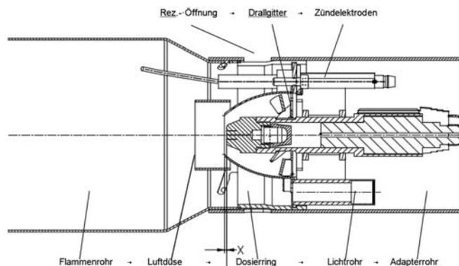
Abb. 96: Die Elektroden sind ca. 10 mm nach oben gebogen.
